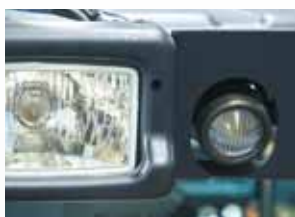
Pracovní světla integrována v nové výšce s nastavitelným sklonem
