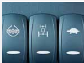
Uzávěrka diferenciálu, 4x4 a plazivý chod zapnutí stisknutím tlačítka
