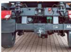
Tažné zařízení max. zatížení 150/250 kg
