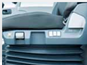
Vzduchem odpružené sedadlo s vyhřevem a bederní opěrkou
